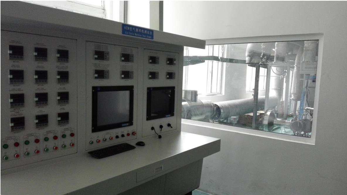
ACM 空气循环机试验系统主要用于测试 ACM 在空载、不同气压下的工作性能，其主要测试内容包括外部泄漏测试、功能测试和电气连接测试，能测量 ACM 空载时的转速与各进出口气压、温度、旋转轴振动峰值和轴振动测试等。
