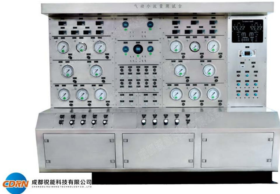
本试验台设计为中小流量气动附件提供通用测试，可对开关活门、调节活门、流量控制活门、空气止回活门、启动活门、电磁活门、伺服活门及温度活门进行相关测试，可满足绝大多数飞机中低流量气动附件的维修测试要求。本测试台提供手动和自动测试功能，用户可根据不同的测试对象进行二次开发，重新定义测试流程。
