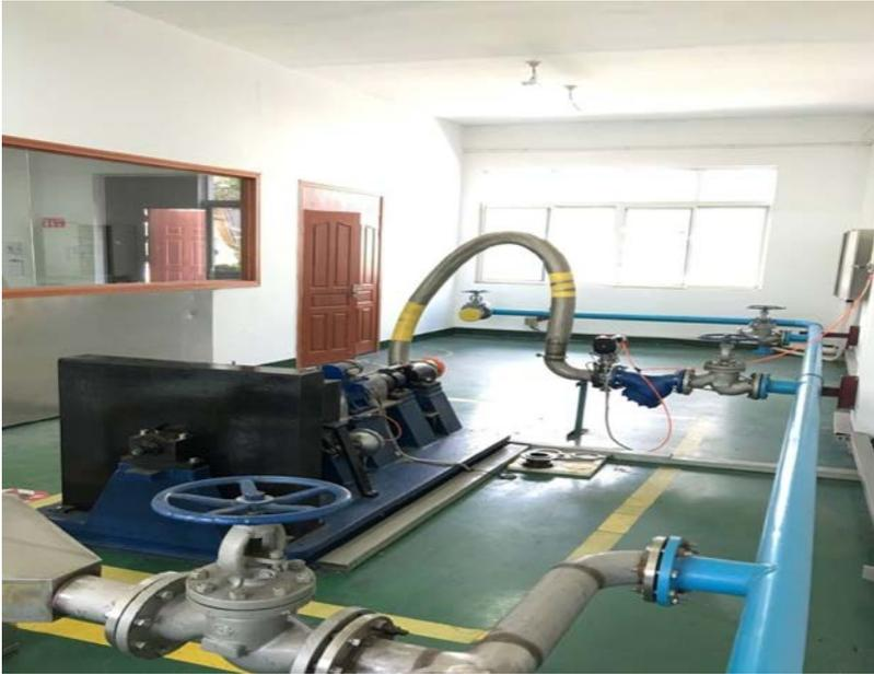
本试验台可针对目前国内正在运营的民航及军用飞机大发的空气起动机 (ATS) 进行全功能测试，包括B737、B747、B777、A320、A330、MA700等。加载方式采用飞轮加载，也可根据用户的预算和技术需求选择其他加载方式。
